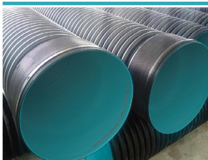
Delimično perforirane drenažno-kanalizacione cevi su idealna kombinacija perforirane i sabirne cevi. Ako se to zahteva one moraju biti u stanju da skupljaju i transportuju bilo koju površinsku vodu koja se zadesi, na kratku i veliku udaljenost. Guma se ubacuje u prvi kanal rebraste cevi, a muf se podmazan navlači preko podmazane gume.
